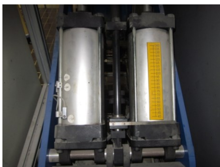
Figura 3.5 Guida per la regolazione dell'altezza delle piastre
