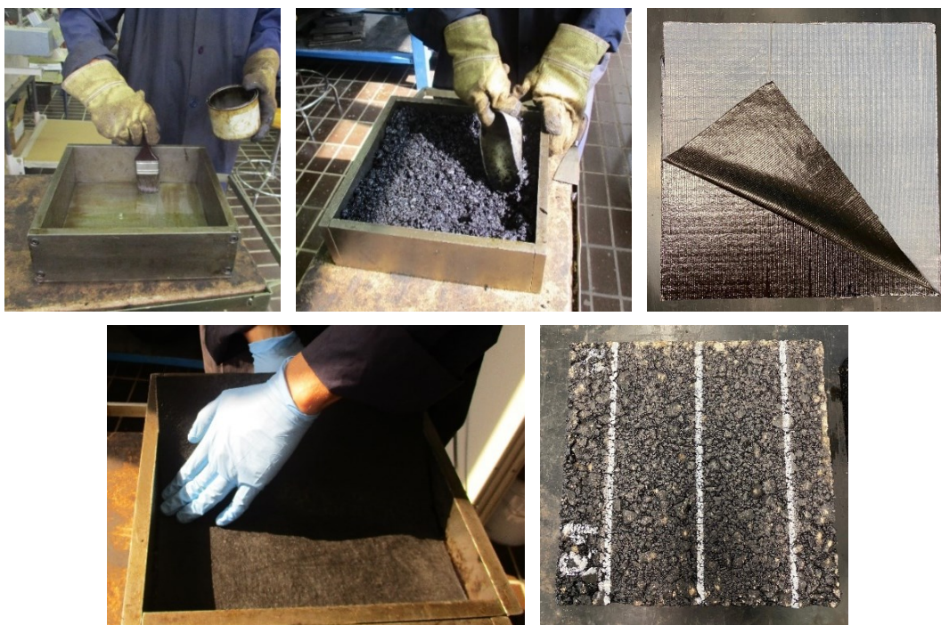
Figura 3.6 Fasi di confezionamento delle piastre bistrato
