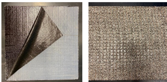
Figura 2.4 sx) superficie inferiore termo-adesiva protetta da film siliconato removibile; dx) superficie superiore del geocomposito
